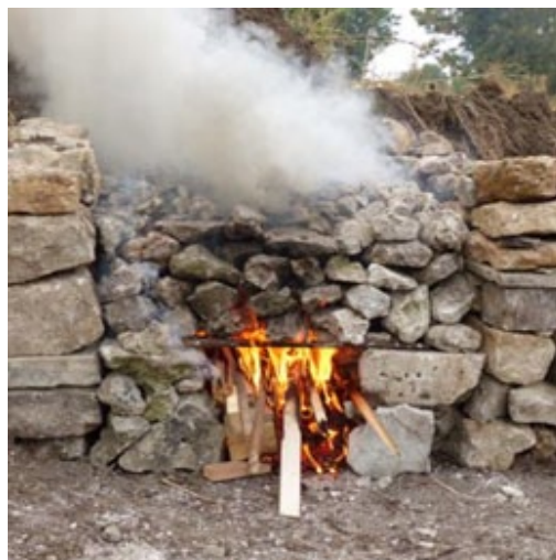
A gauche : cuisson de plâtras sur le site des Murs à Pêches de Montreuil.
