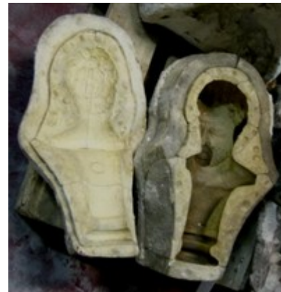
Moule du buste de Démosthène (Atelier de moulage de la RMN, réf. L 350 bis). Trois pièces en mastic ont été repérées : sur la bouche, l'oreille droite et l'oreille gauche. Photo Jacques Laurent.
