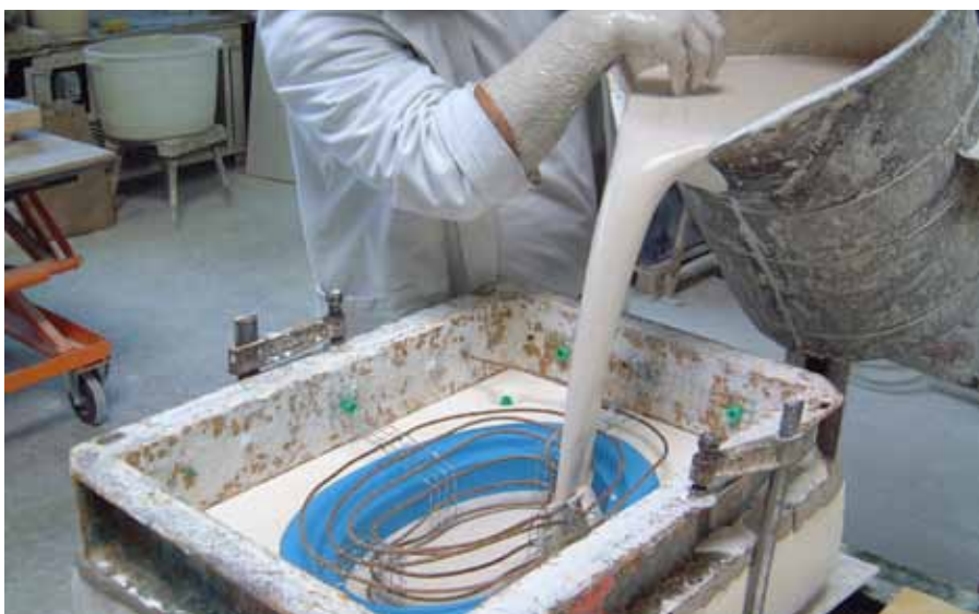
► Fabrication d'un moule de pressage (Staub / Soufflenheim 67)
