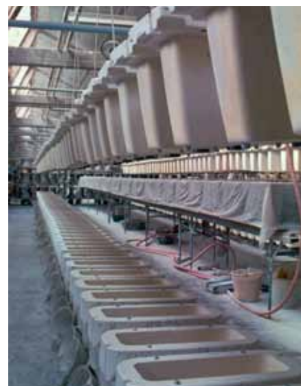
► Moules de réservoirs WC (Porcher / Gargenville 78)
